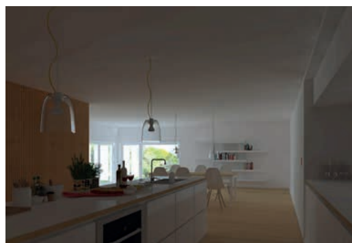
Fasádne okno nedokáže presvetliť miestnosť do hĺbky.
