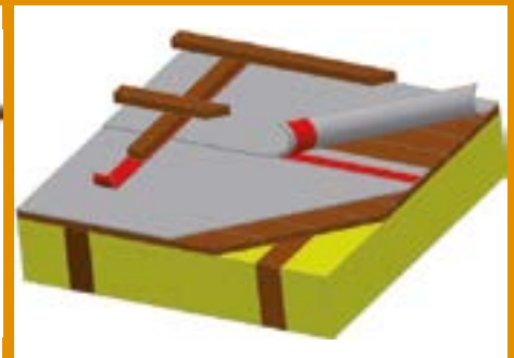
Na debnení – zateplené podkrovie.
