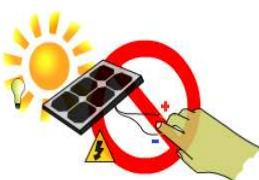
Pri inštalácii solárnej strešnej škridle alebo spojovacích káblor je vhodné batérie zakryť po celej ploche. Tým sa zníži riziko úrazu elektrickým prúdom.
