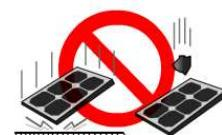
Solárny článok by nemal byť voľne položený bez podpory povchu, pretože by sa mohlo rozbiť sklo. Poškodený modul sa už nedá opraviť. Pri inštalácii sa uistite, že výrobok nie je vystavený bočnému tlaku alebo nárazom!
